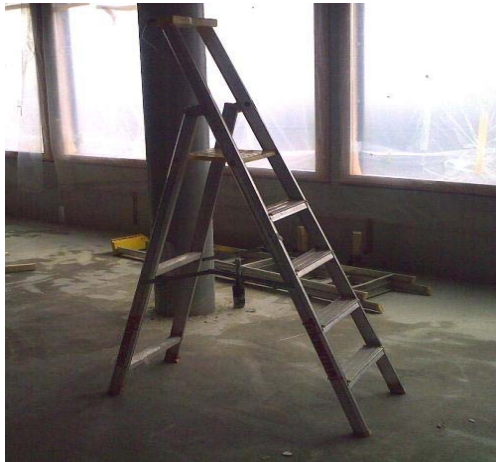
Kuva 1. Tätä saa käyttää vain, kun työntekijä seisoo niillä alle metrin korkeudessa. Suositus: Ilman sivuttaistukia olevia A-tikkaita ei käytetä!
