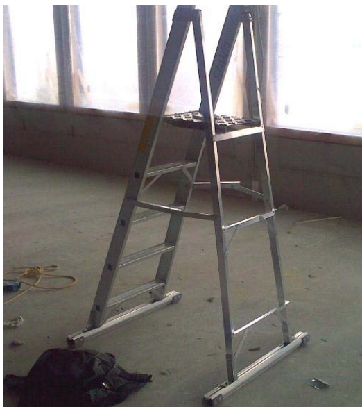
Kuva 2. A-tikkaita joiden seisontavakavuus on varmistettu esim. sivuttaistuilla saa käyttää myös silloin kun työntekijä seisoo niillä 1-2 metrin korkeudessa (alatukipalkin leveys väh. 90 cm).
