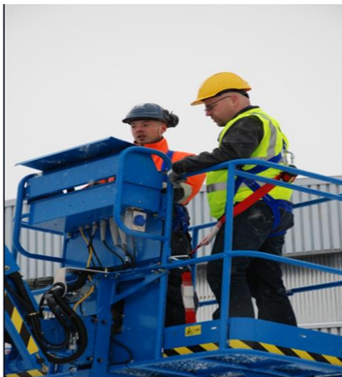
Kuva 6. Liikuteltavissa henkilönostimissa käytettävä aina putoamissuojaimia
